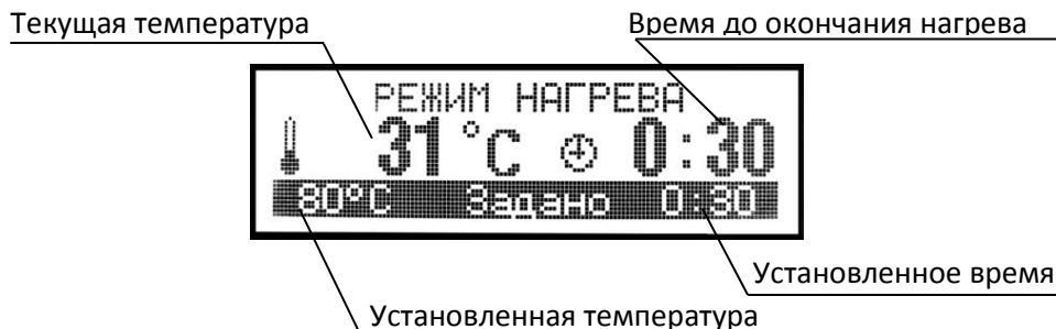
Рисунок 8 – Вид дисплея в состоянии нагрева в течение установленного времени
